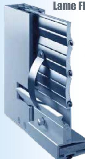
La lame finale en aluminium extrudé est renforcée par un plat acier de 40 mm de largeur par 8 mm d'épaisseur (poids de 4 Kg au mètre linéaire). Lorsque le tablier est descendu, les lames se tassent permettant ainsi à un profil aluminium robuste de basculer et de venir se loger dans des entailles usinées dans les coulisses. Cet astucieux dispositif offre une excellente résistance au soulèvement.
