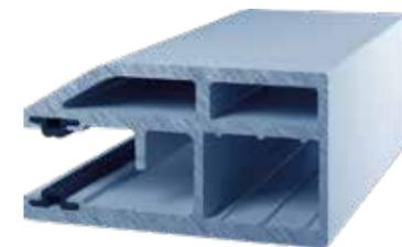
Les coulisses de sécurité en aluminium, renforcées, ont une conception intelligente qui leur confère une très grande résistance. Des dimensions mini de 68 x 35 mm et une épaisseur de matière jusqu'à 4 mm permettant d'obtenir un profil robuste d'un poids de 2,2 kg au mètre linéaire (contre moins de 500 g pour un volet classique) Une double chambre côté attaque démultiplie la résistance sur la face la plus exposée.
