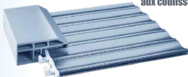
Des embouts métalliques (crochets) sont vissés à chaque extrémité des lames qui, en cas de fortes sollicitations sur le tablier, viennent se plaquer sur les ailes intérieures des coulisses assurant un maintien extrêmement efficace.
